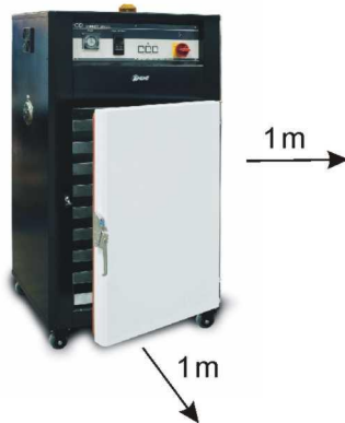
图 3-1: 安装机器要求图
